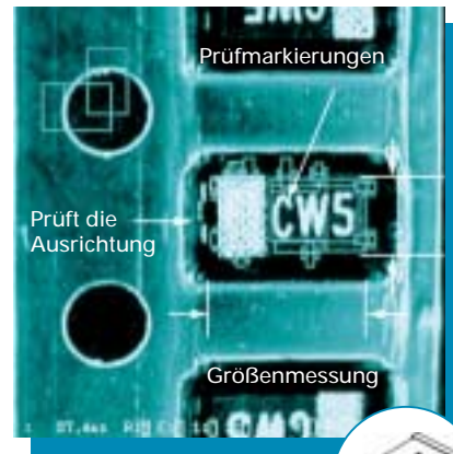
Lage- und Maßkontrolle von Kondensatoren
