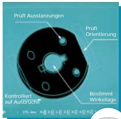
Maß- und Positionskontrolle mechanischer Bauteile
